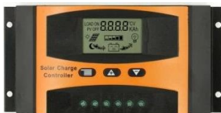
8-сурет . Зарядтау контроллері
