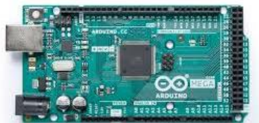
17-сурет - Arduino Mega 2560
