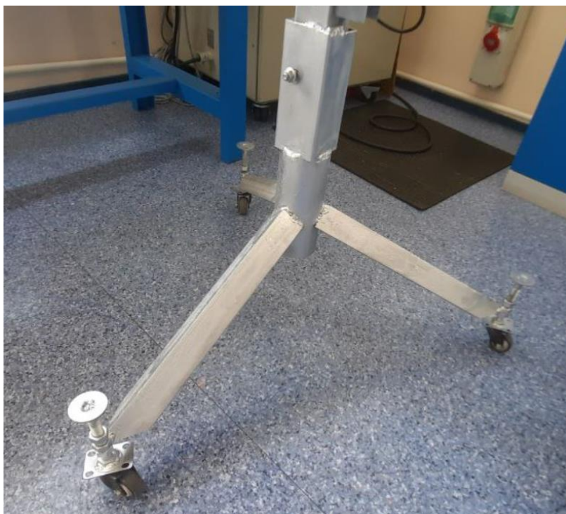
13-сурет - Күн трекерінің тірек құрылымы
